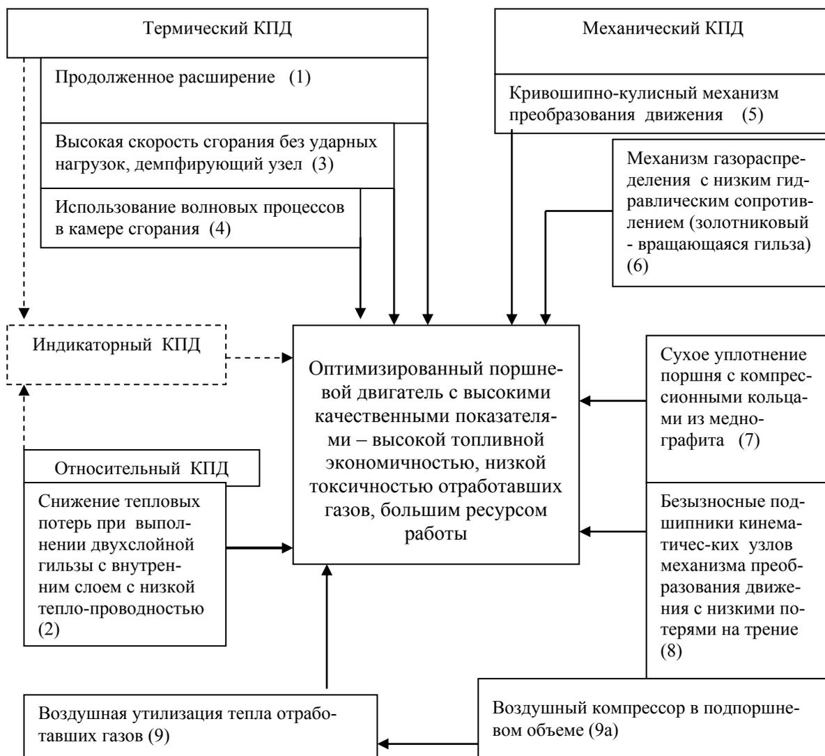
Рис. 1. Блок-схема совершенствования двигателя за счет оптимизации параметров и положительного влияния на все составляющие эффективного КПД: термического, относительного (индикаторного), механического, а также применения воздушного утилизационного цикла
